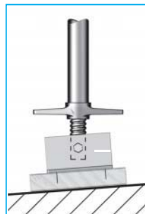
Socle à rotule sur sol en pente avec un madrier
